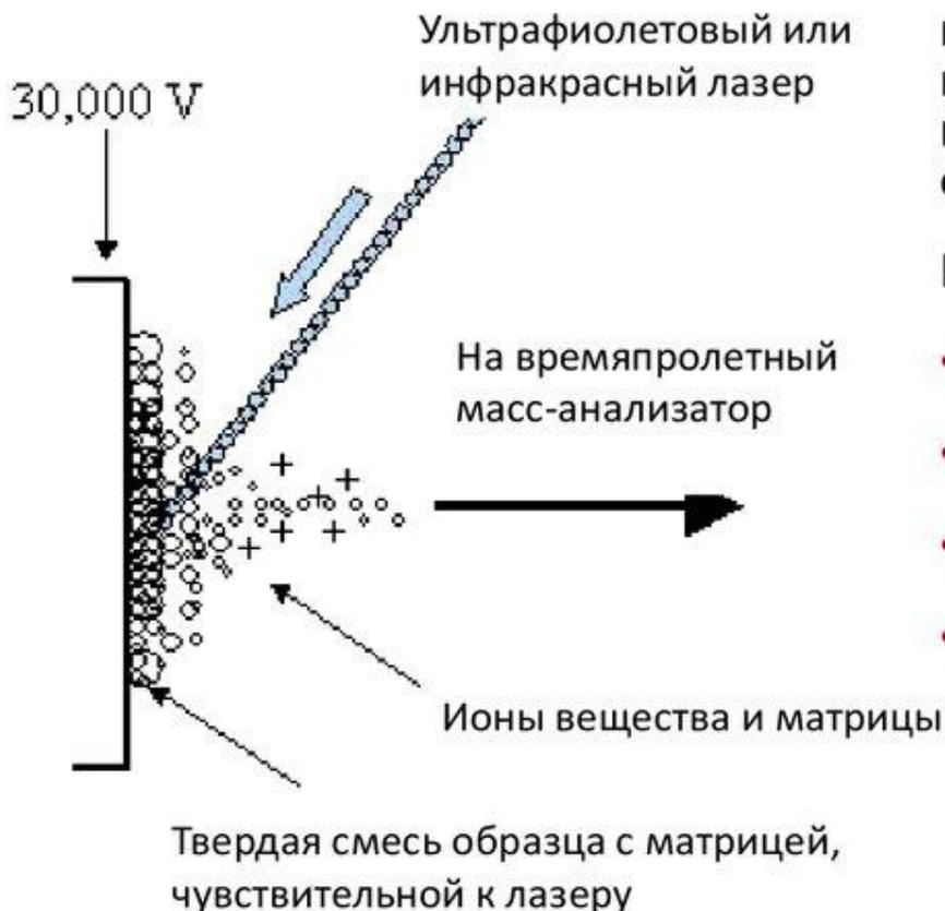
**MALDI-TOF-MS** – тип масс-спектрометрии, в котором анализируемые вещества мягко ионизируют с помощью лазера, действие которого опосредует высоко чувствительное к его излучению вещество – матрица.
